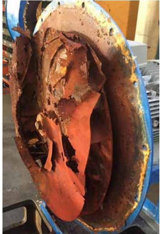
**Rottura girante ventilatore standard in impianto biogas**
