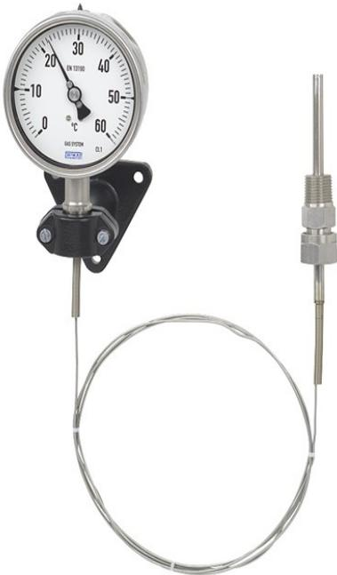
Termometro a quadrante con capillare: questa combinazione è possibile solamente con strumenti funzionanti sul principio dell'espansione di gas.
