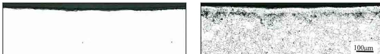
**Fig. 12- Micrografia di un campione di TEMPALOY AA-1 pallinato all'interno ed esposto a vapore a 750°C per 1 kh; a sx: lucidato; a dx: dopo attacco chimico**
