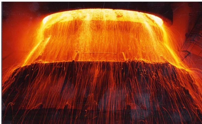
Figura 2.2: Il convertitore a ossigeno
