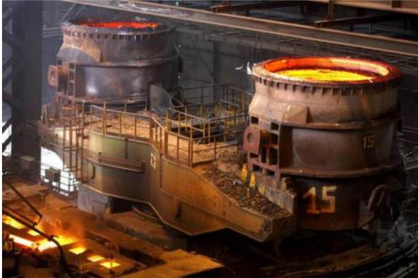
Figura 2.3: Siviere caricate sul braccio mobile della colata continua
